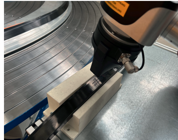
Bild 2. Gestochen scharf und innerhalb weniger Sekunden bringt der Quasar 20 beispielsweise Logo, Chargennummer oder Teilenummer auf. © Freudenberg Sealing Technologies
